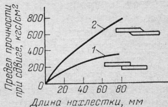
Рис. IV.36. Зависимость предела прочности при сдвиге клеевого соединения от длины нахлестки для образцов с прямыми (1) и скошенными (2) кромками [210].
