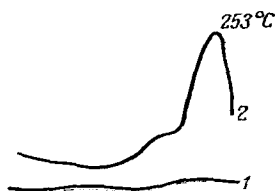
Рис. X.16. Термограмма [126] чистой эпоксидной смолы (1) и эпоксидной смолы, содержащей 14 вес. ч. высокодисперсного свинца (2).
